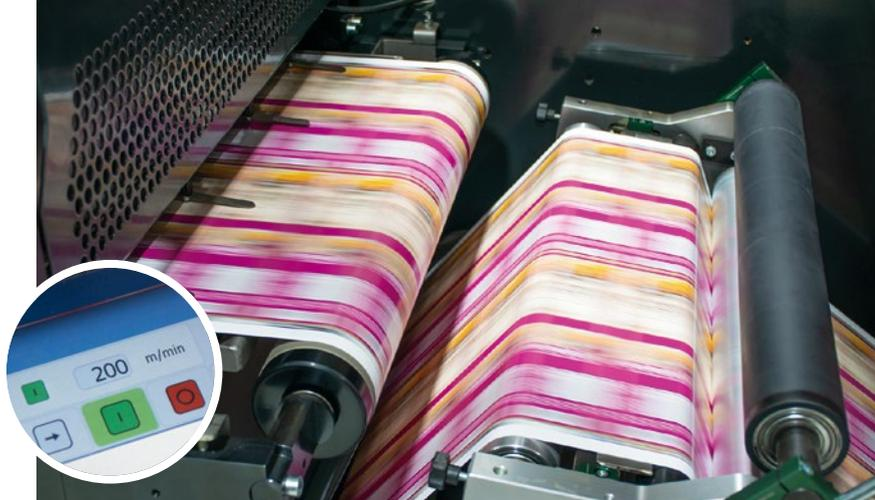
La prensa flexo EFA 530 de MPS ofrece una velocidad de impresión de 200 m/min.
