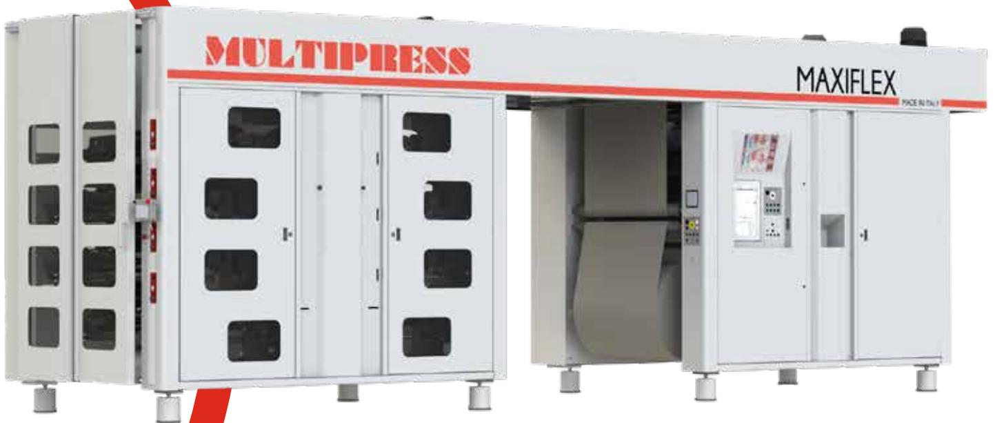
Estudiada y diseñada para impresiones de medio y corto tiraje. Tecnología de cambios rápidos con sistema de mangas en ánulo y clichés. Totalmente electrónica con pre-ajustes de impresión y registros.
