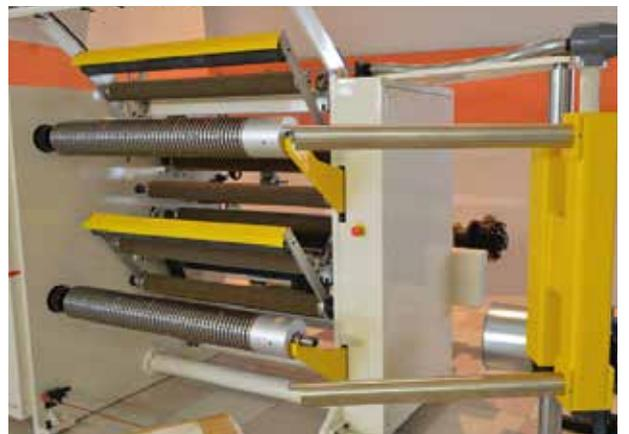
Descarga de las bobinas cortadas hacia el dispositivo de descarga manual con rotación axial
