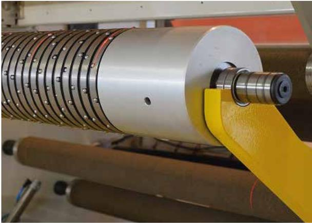
Ejes de rebobinado con sistema de anillos friccionados con esferas, para trabajar con una amplia tipología de materiales con grandes variaciones de espesor a todo lo ancho
