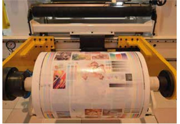
Desbobinador con sistema hidráulico shaftless con movimiento independiente o simultáneo de cada brazo
