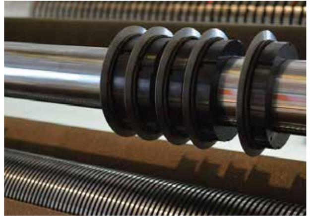
Sistema de corte de discos tangenciales con motor A.C. asíncrono. El sistema consiste en un eje superior donde están posicionados los cinco (05) discos de corte y un eje inferior de contra corte
