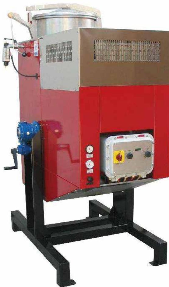
Destiladores (ATEX) para la recuperación de solventes agotados utilizados en operaciones de limpieza de piezas de máquinas de impresión en contacto con tintas base solvente.
